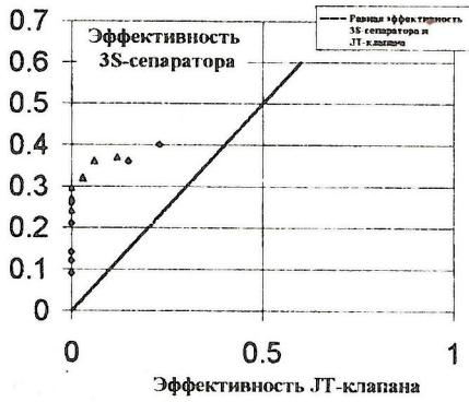
Рис.6. Сравнение эффективности 3S-сепаратора и устройств, базирующихся на дросселировании газа в JT-клапанах.
